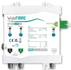
Ricevitore Wide Fibre che converte il segnale ottico proveniente dal trasmettitore OPT-TX WB1 in segnale coassiale; dispone di 3 uscite: le 2 polarità satellitari **wideband V ed H** e il segnale **TV**.
